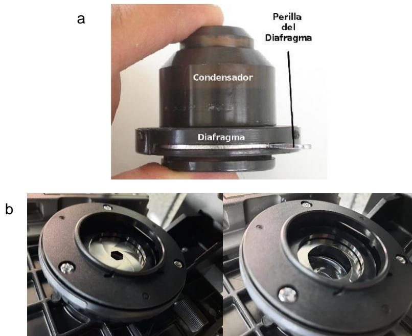
**Figura 6.** Diafragma del M.O. a. Diafragma situado debajo del condensador. b. Diafragma óptico con diferentes niveles de apertura. Extraído de: <https://edu.glogster.com/glog/el-microscopio/22kody45wc0?=&glogpedia-source>.
