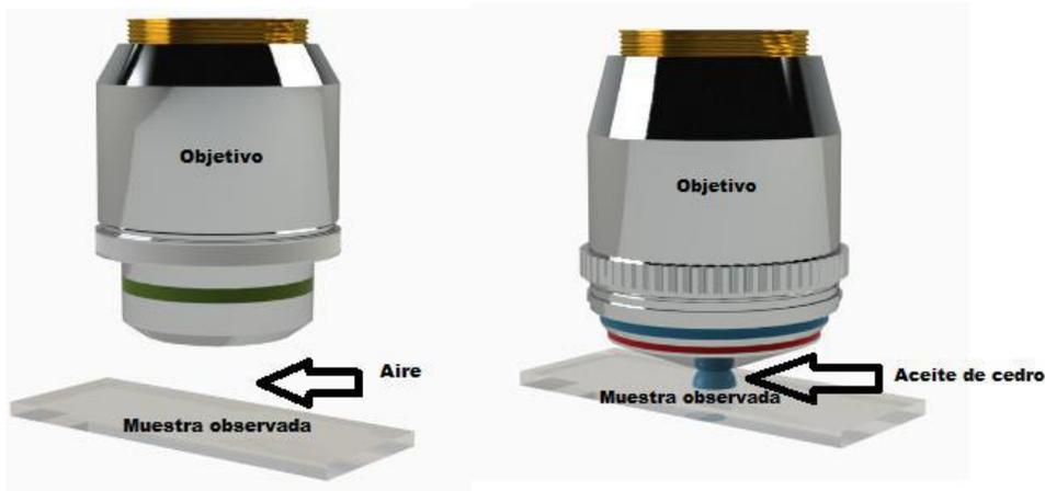
**Figura 8.** Izquierda: Objetivo a seco, se observa que entre el objetivo y la muestra existe una película de aire. Derecha: Objetivo a inmersión, se observara que el objetivo de 100X está en contacto con la muestra mediante el uso de aceite de cedro, el cual presenta índice de refracción similar al vidrio.
